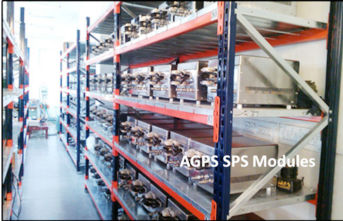
चित्र B.2.8 आयन साइक्लोट्रॉन प्रोटोटाइप उच्च वोल्टता शक्ति आपूर्ति का ईटर प्रयोगशाला में सफलतापूर्वक कमीशन किया गया एवं 27/18kV के दोहरे उत्पादन के साथ 3MW शक्ति के लिए प्रदर्शित
