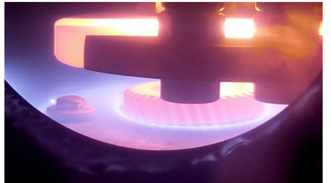
चित्र B.1.1 (बाएँ) तापन प्रक्रिया के दौरान नमूना तप्त लाल में हो जाता है। (दाएँ) प्लाज़्मा कार्बुराईजिंग प्रक्रिया के दौरान नमूने के आसपास प्लाज़्मा
